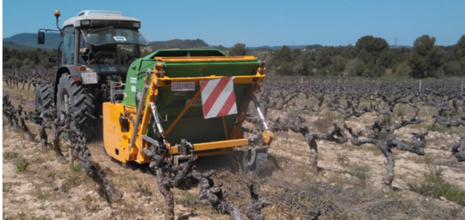
Recogedora-trituradora. Permite utilizar el sarmiento directamente en las calderas una vez seco.
